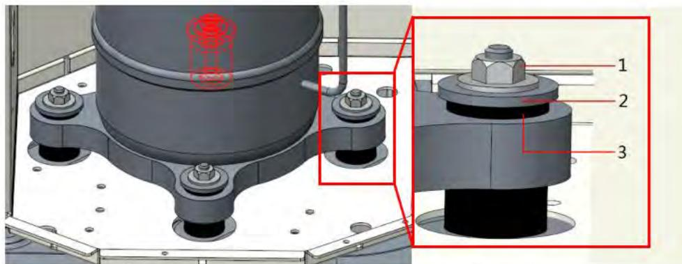
1—nut    2—gasket    3—damping washer
